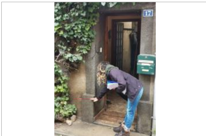
17 rue du pont de l'Hers 40 cm de hauteur d'eau - Photo ©AGERIN
