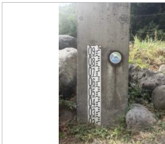
Plot béton avec échelle limnimétrique et repères de crue, DEAL Réunion, 2023
