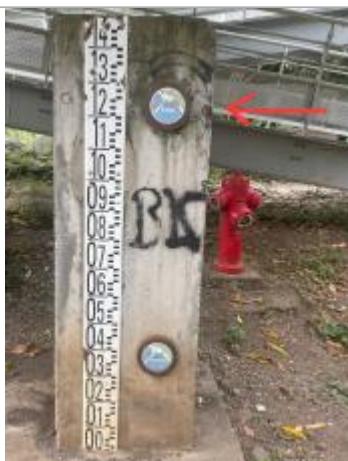
Plot béton avec échelle limnimétrique et repères de crue, DEAL Réunion, 2023
