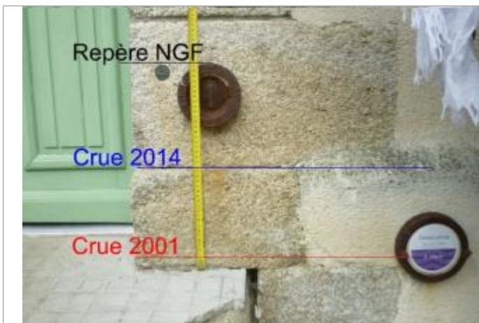
Comparaison niveaux des crues de 2001 et 2004 sous le repère de nivellement IGN
