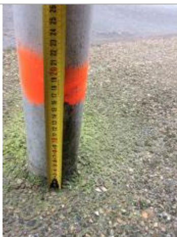
hauteur de l'eau sur le poteau du feux tricolore
