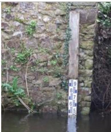
Echelle limnimétrique dans le bourg de Montreuil sur Ille
