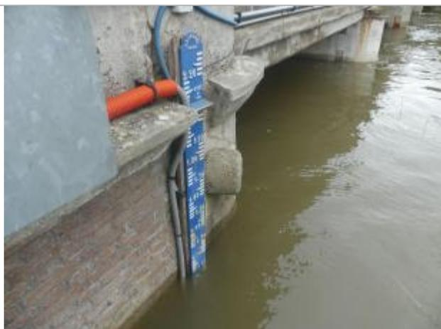
Vue sur l'échelle pendant la crue, avec la marque laissée par l'eau sur la gauche lors du maximum de la crue (source : U2HE SACN)
