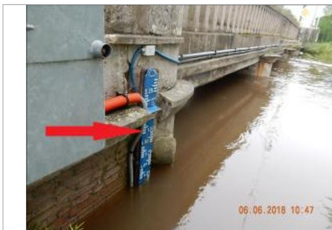
Hauteur mesurée à la station(1,923 m) au droit de l'échelle limnimétrique.
