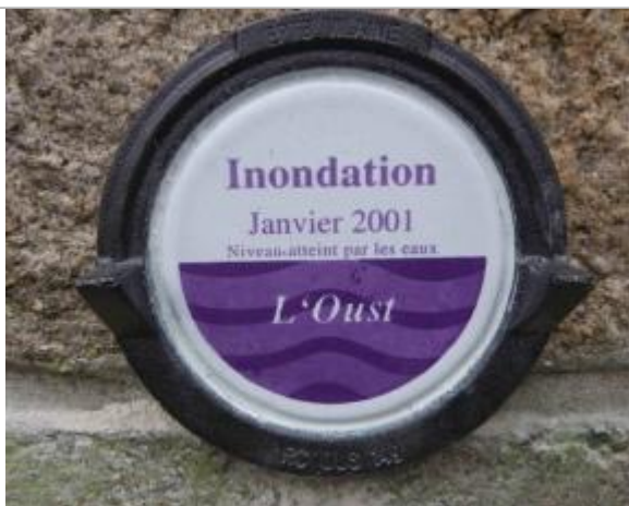
Repère normalisé de la crue de janvier 2001
