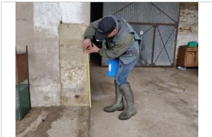
Repère (ancienne trace) du maximum de la crue de 1981 sur mur en pierre du préau de la ferme
