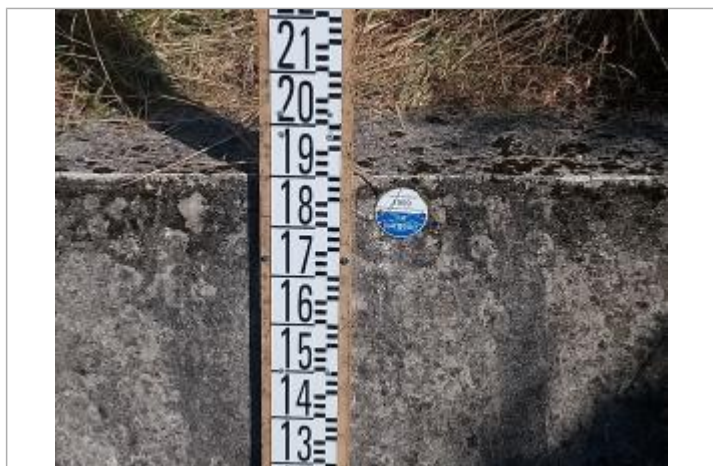
Repère de crue en rive gauche du Surgeon
