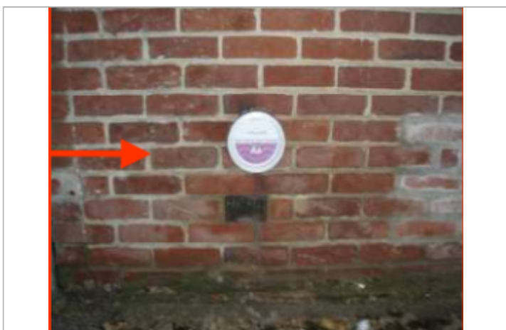
Repère sur la façade de la salle du Chocquet, à proximité des terrains
