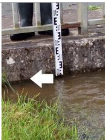
Marque de la laisse et position de la mire mesurant la différence entre le niveau max de la crue et le dessus du rebord du pont.
