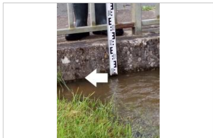
Marque de la laisse et position de la mire mesurant la différence entre le niveau max de la crue et le dessus du rebord du pont.
