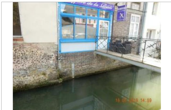
Vu sur l'échelle limnimétrique. L'eau est arrivée 55 cm sous la passerelle en 2001 (source : SPC SACN)
