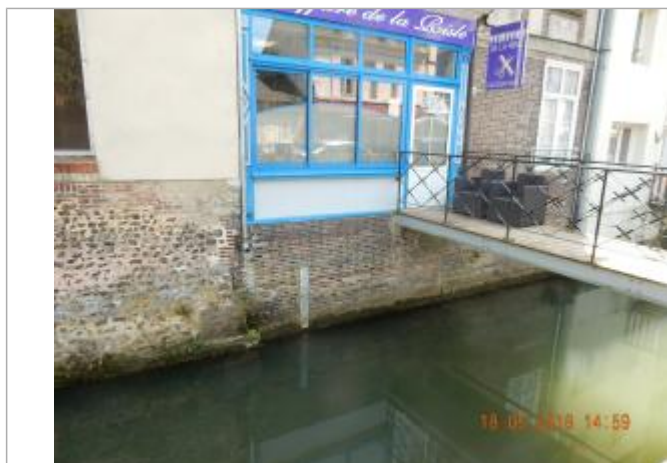
Vu sur l'échelle limnimétrique. L'eau est arrivée 55 cm sous la passerelle en 2001 (source : SPC SACN)
