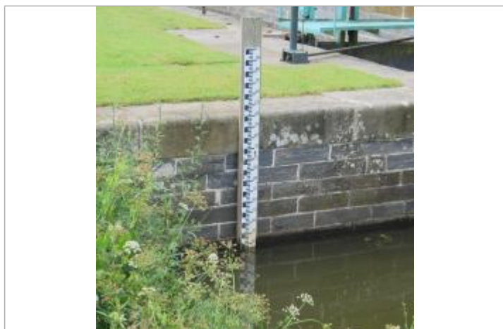
Echelle limnimétrique à l'amont de l'écluse de Mons à Bruz
