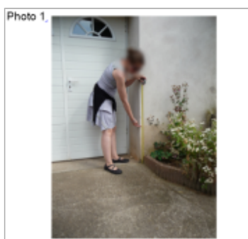
trace du maximum de la crue sur la façade à côté de la porte d'entrée du 2 rte de Serre
