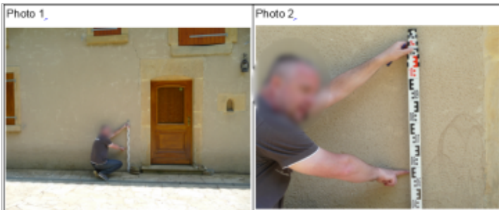
Trace du maximum de la crue sur la façade à côté de la porte d'entrée du 2 rue de l'Yron commune de Ville-sur-Yron
