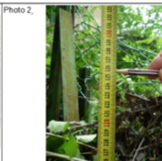
Trace du maximum de la crue sur le piquet d'angle de la clôture du 6 rue de DOUAUMONT
