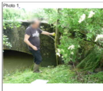
Trace du maximum de la crue sur le tronc de l'arbre à côté du pont sur le chemin communal
