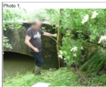
Trace du maximum de la crue sur le tronc de l'arbre à côté du pont sur le chemin communal
