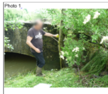
Trace du maximum de la crue sur le tronc de l'arbre à côté du pont sur le chemin communal
