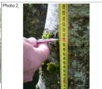
Trace du maximum de la crue sur le tronc de l'arbre à côté du pont sur le chemin communal
