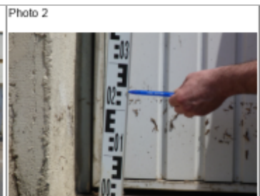
Trace du maximum de la crue sur la façade et la porte de garage du 11 rue de la filature
