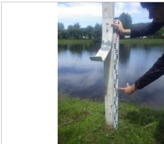
Trace d'inondation à 55 cm sur le piquet à partir du sol (source : SIBVR)
