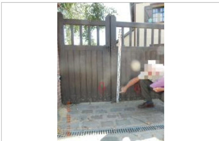
Laises d'inondation sur le portail (photo SPC SACN)
