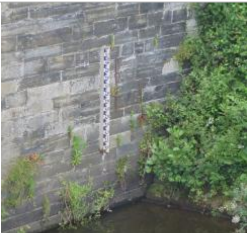
Echelle limnimétrique sur le pont de la route de La Planche à l'aval de l'écluse d'Apigné
