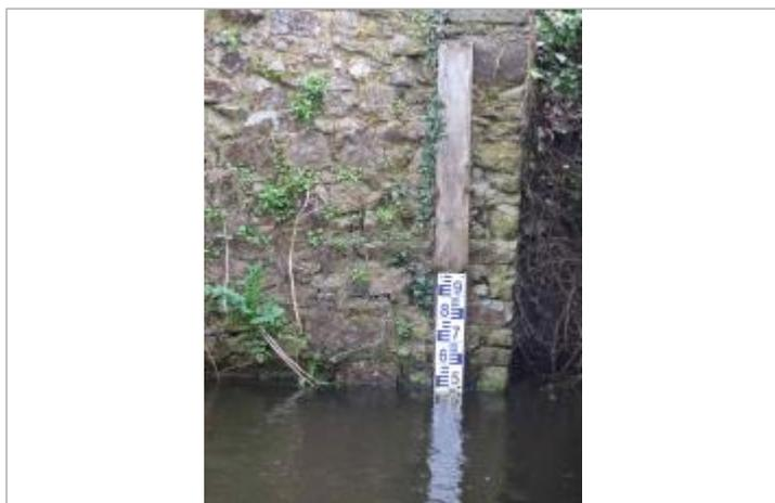
Echelle limnimétrique dans le bourg de Montreuil sur Ille
