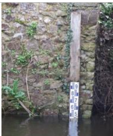
Echelle limnimétrique dans le bourg de Montreuil sur Ille
