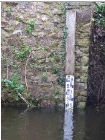
Echelle limnimétrique dans le bourg de Montreuil sur Ille
