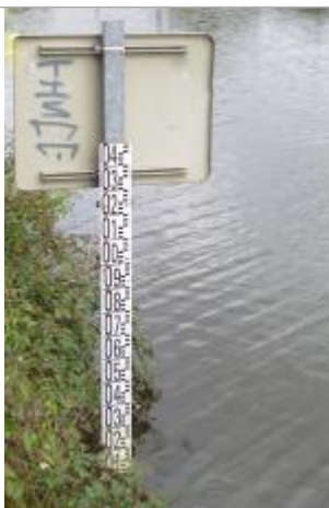
Echelle limnimétrique de la maison éclusière St Martin à Rennes
