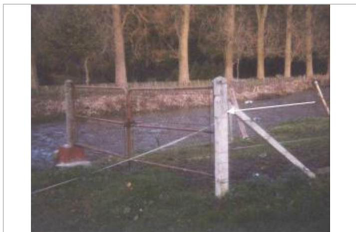
Eau arrivée jusqu'à l'encoche, au-dessus de la bande sur le poteau situé en bout de chemin (Source: SAFEGE)
