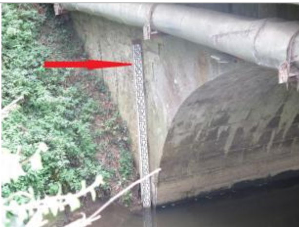
Echelle limnimétrique de l'ancienne station de Pont d'Etelles
