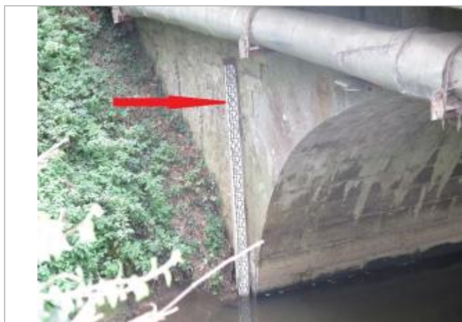
Echelle limnimétrique de l'ancienne station de Pont d'Etelles
