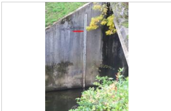
Echelle limnimétrique de la station de Chateaubourg.
