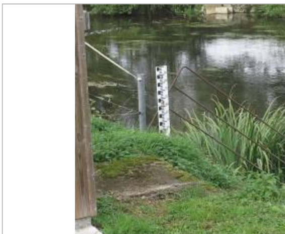
Echelle limnimétrique de la station de Pont Briand
