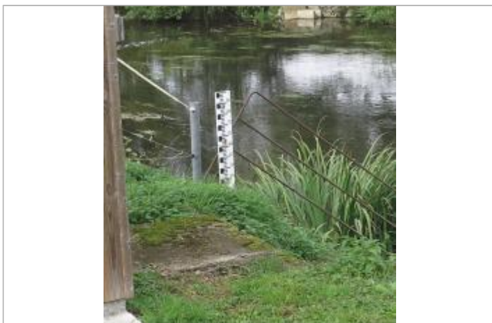
Echelle limnimétrique de la station de Pont Briand
