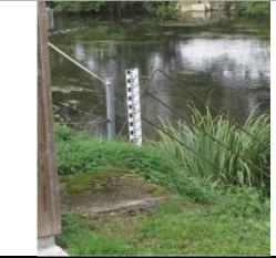
Echelle limnimétrique de la station de Pont Briand
