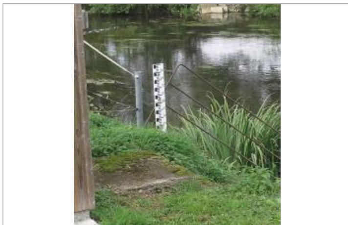
Echelle limnimétrique de la station de Pont Briand
