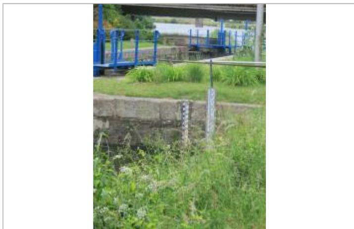
Echelle limnimétrique sur le bajoyer amont de l'écluse de Guipry
