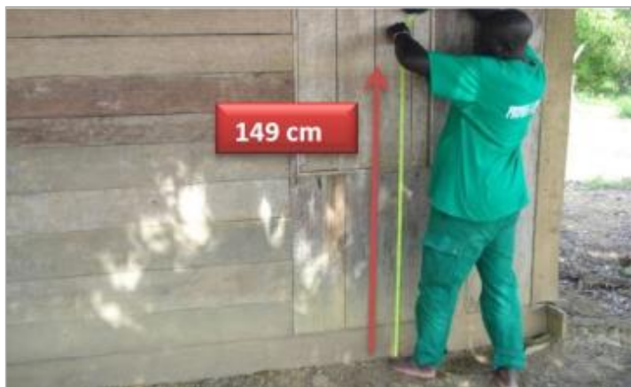
Vue du support et de la mesure du niveau des PHE
