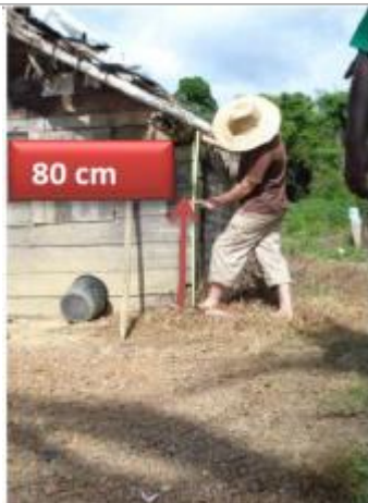
Vue du support et de la mesure du niveau des PHE
