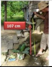
Vue du support et de la mesure du niveau des PHE
