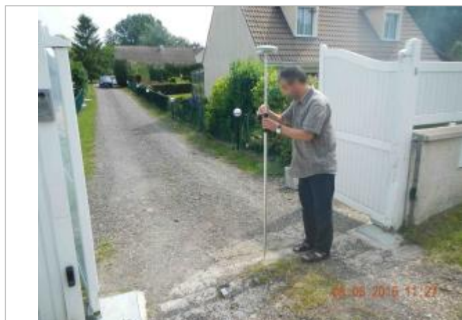
Limite maximale de la zone inondée au niveau du seuil du portail
