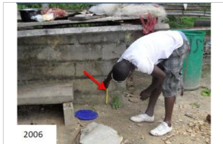
Vue du support et de la mesure du niveau des PHE
