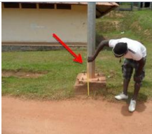
Vue du support et de la mesure du niveau des PHE
