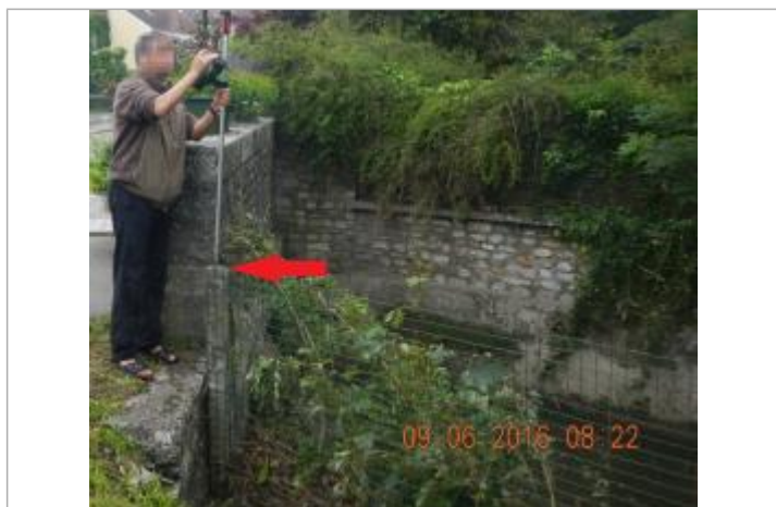
Laisse végétale déposée sur le haut du grillage de la rive gauche juste avant le pont
