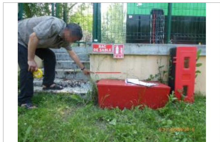
Marque horizontale laissée par la crue au dessus d'un bac de sable sur le parking
