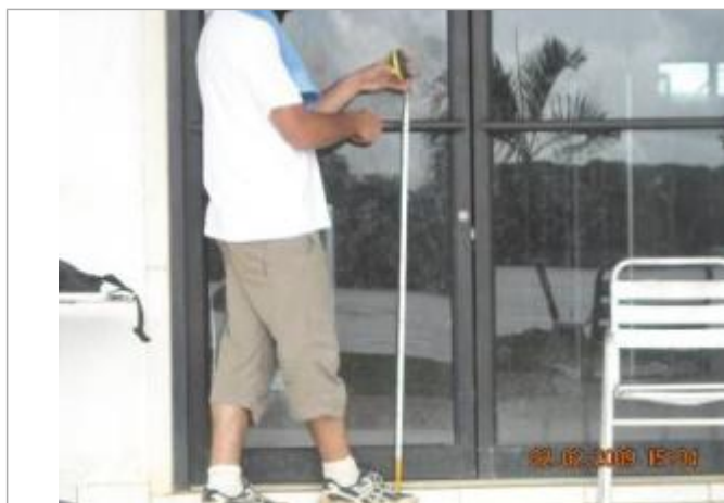
Vue du support et de la mesure du niveau des PHE
