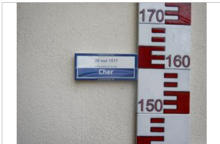
Repère de la crue du 29 mai 1977
