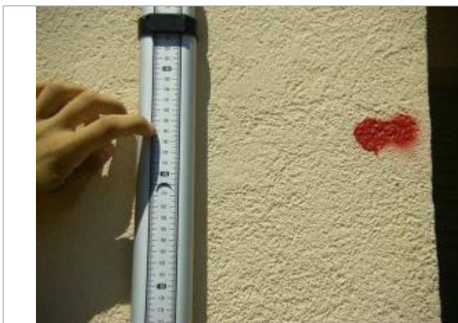
Vue de la PHE - Auteur : EGIS
