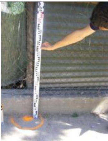
Vue de la PHE - Auteur : EGIS
