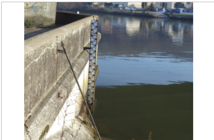
Echelle de crues, repère du 6 février 1995 à 29,31 m NGF normal
