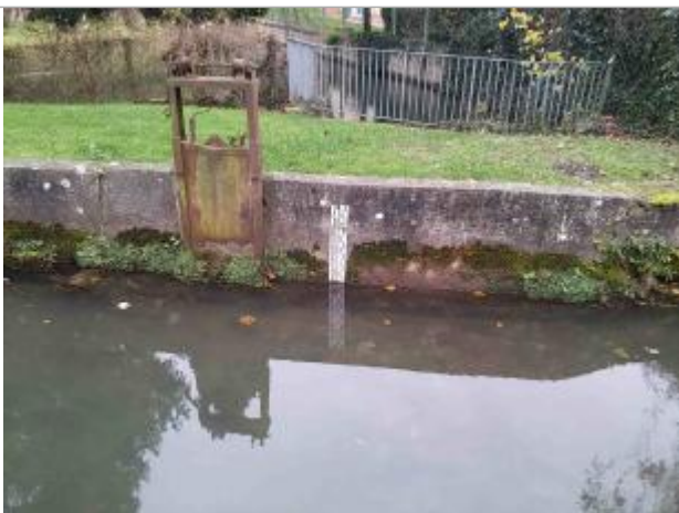
Echelle de crues sur rivière St Just
